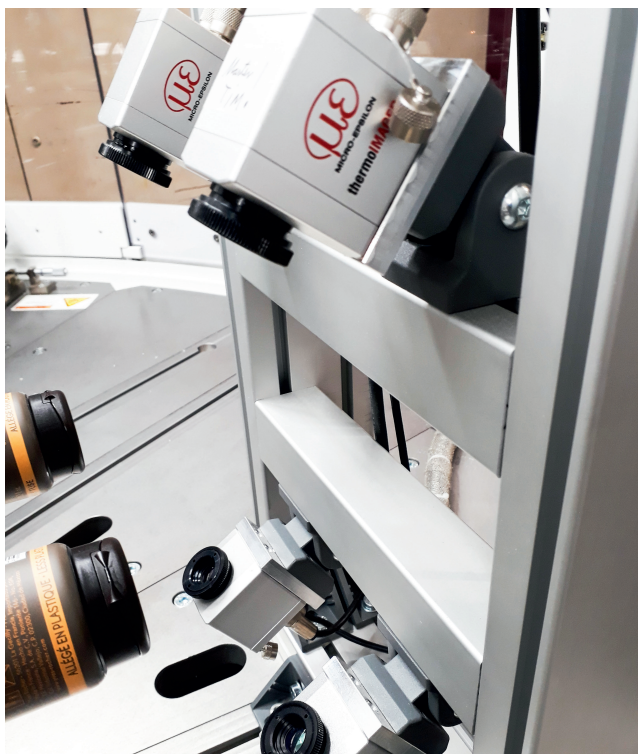
Bild 1. Anordnung der vier Kameras in der Ultraschall-Schweißanlage zur Beurteilung der Schweißnähte zur Verbindung von Deckel und Tube (© SKZ)
